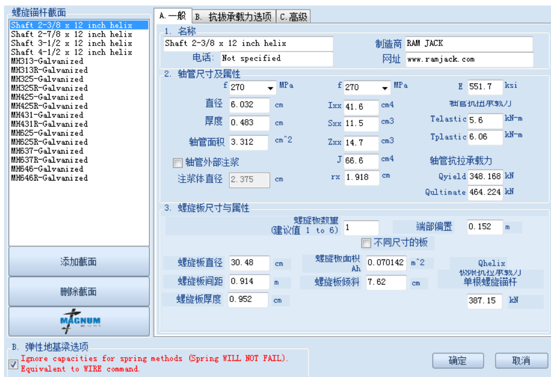
图 3.8.7 螺旋锚杆截面
