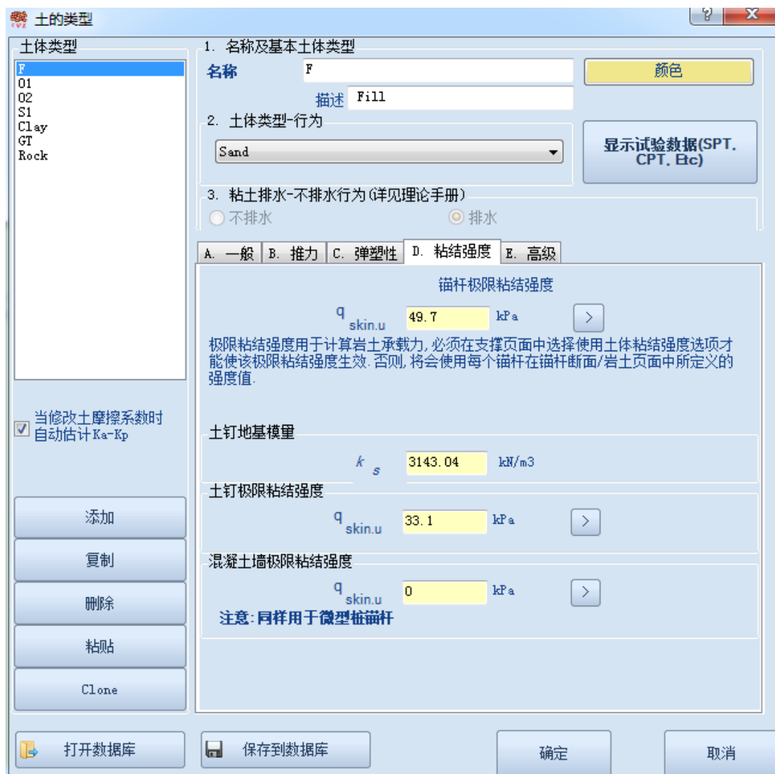
图 3.4.8 锚杆极限粘结强度
